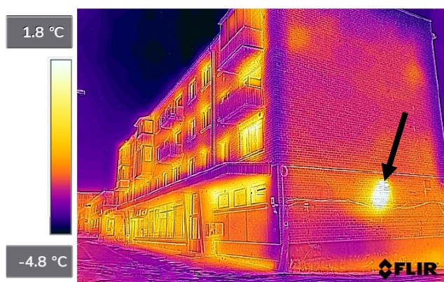
5 pav. Kretingos g. 52, statybos metai – 1963 m., baltų plytų daugiabučio namo termovizinė ir įprasta nuotraukos
